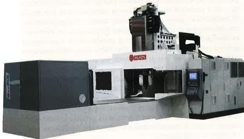
dal peso ridotto al minimo delle masse mobili. La precisione nelle lavorazioni è garantita dagli azionamenti degli assi lineari, comandati da motori collegati direttamente alle viti a ricircolo di sfere, e dal sistema di compensazione idraulico studiato per controbilanciare il peso della testa verticale.
